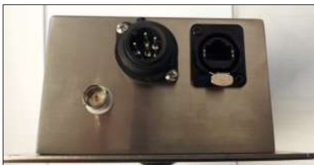
Figura 5 - Connettori dell'Help Point per ascensori
