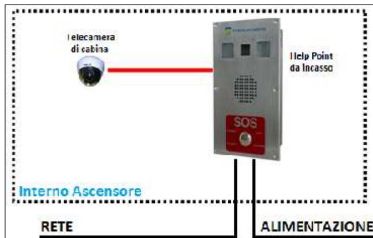
Figura 6 - Connessioni all'interno della cabina
